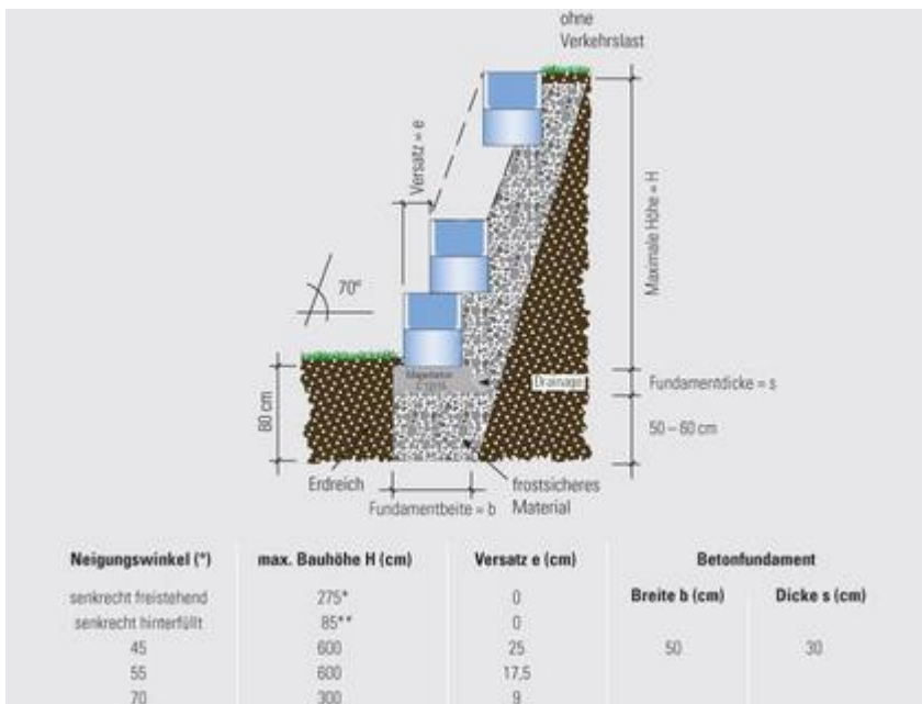
Böschungsbefestigung mit 70°-Neigung
