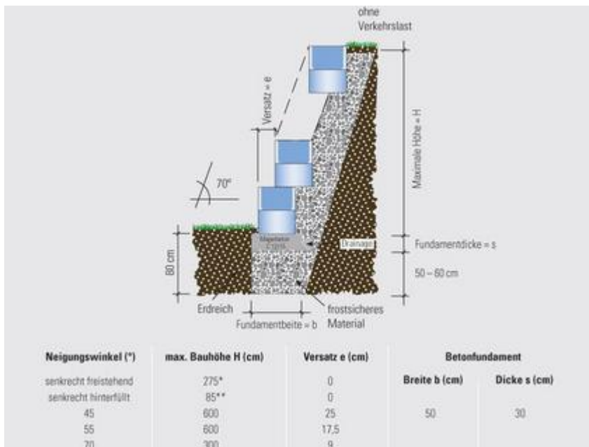
Böschungsbefestigung mit 70°-Neigung
