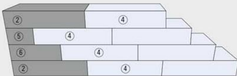
Construction de bord de mur avec décalage étagé d'un tiers de pierre
