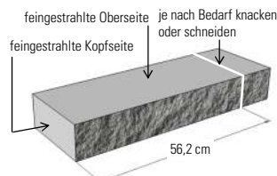
Eckelement im Halbversatz: Bauteillänge: 56,2 cm
