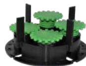
Plot réglable réglable en hauteur de 35 à 50 mm, pour des joints de 2 mm de large. La hauteur du joint peut être réduite ou coupée au cutter. ( Convient uniquement pour les dalles grès cérame )
