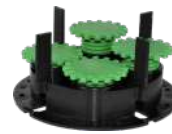
Plot réglable, élément entier, réglable en hauteur de 35-50 mm. Le résultat : des joints de 3 mm de large. Les éléments d'angle et de bord se détachent et se découpent.
